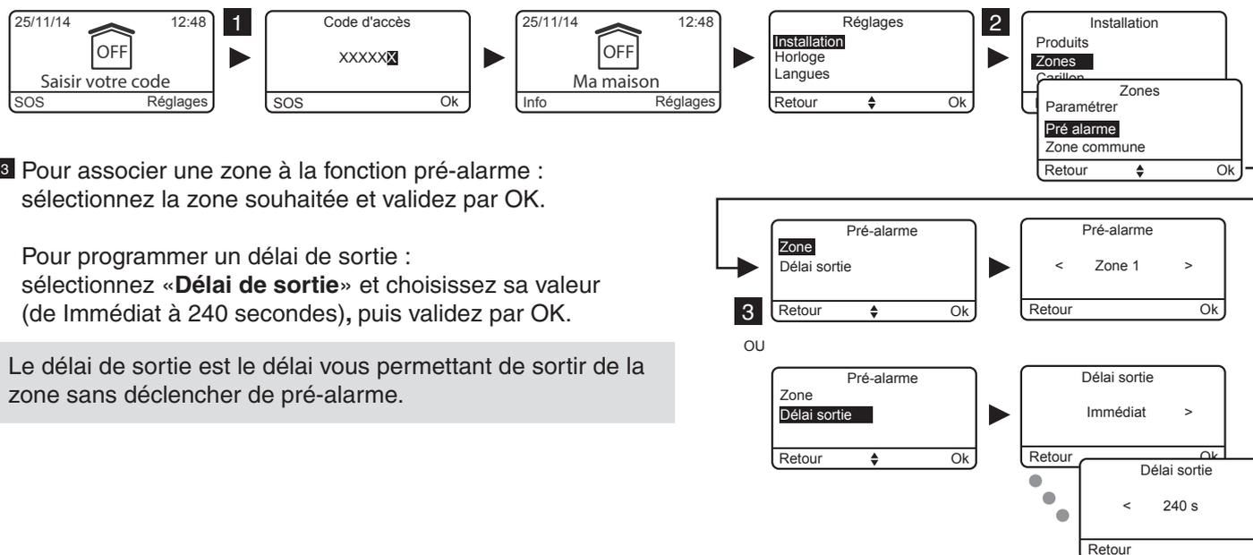
3 Pour associer une zone à la fonction pré-alarme : sélectionnez la zone souhaitée et validez par OK.
