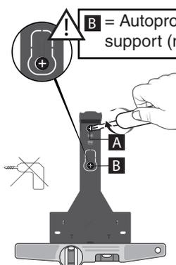
Fixez au mur (vis A et B) le support de fixation (ne pas mettre les vis C et D à cette étape).
