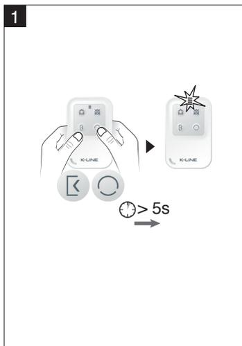
1 Appuyez simultanément 5 secondes sur les touches [K] et [O], jusqu'à ce que le voyant s'allume orange.
