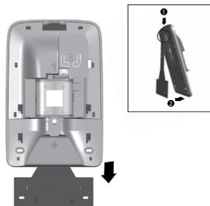
Remontez le socle sur la patte de fixation et fixez-le avec les vis (C et D).
