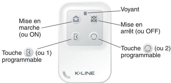
Vous pouvez mettre en marche ou en arrêt votre système d'alarme avec la Télécommande Mini. En fonction de la configuration définie avec votre installateur, les touches [K] et [O] (ou 1 et 2) sont programmables et peuvent avoir différentes fonctions (voir tableau ci-dessous).
