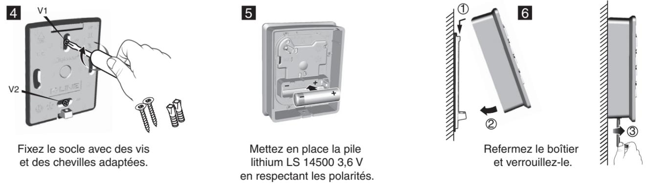
Fixez le socle avec des vis et des chevilles adaptées.
