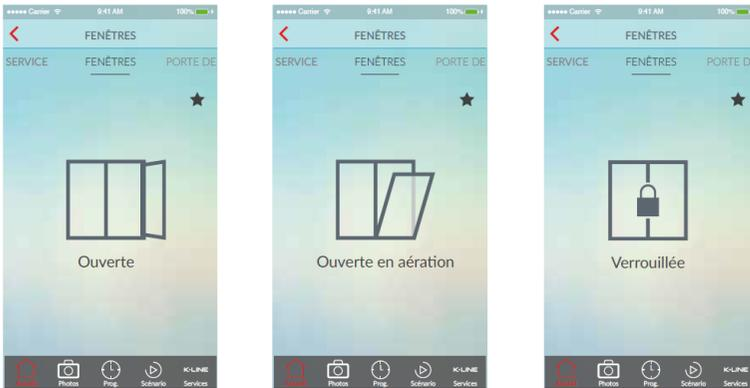
Nota : dans le cas d'une fenêtre oscillo-battante, une 3<sup>ème</sup> position 'Ouvverte en aération' est détectée.
