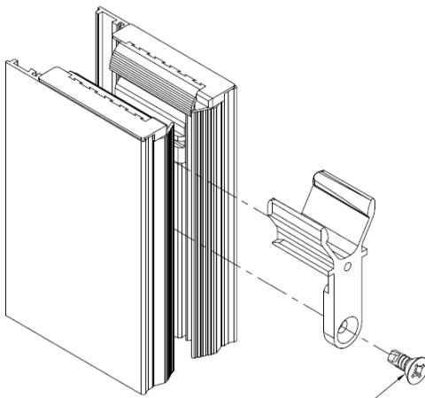
*Mettre en place les anti-dégondages hauts avec les vis autoforeuse SR2 inox 4.8x13 fournies.*
