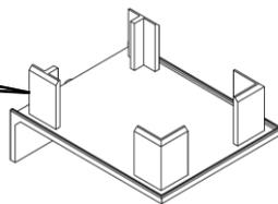
Mettre en place les bouchons avant le gondage des ouvrants
