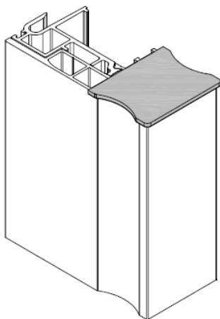
Coller les bouchons sur les montants centraux renforcés. (Bouchons optionnels).
