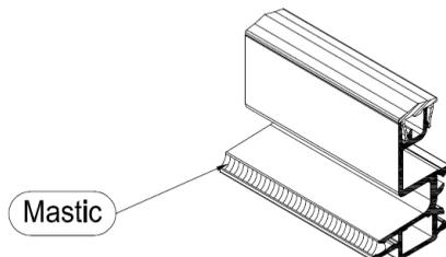
– Réaliser un cordon continu d'étanchéité (agrée SNJF) entre la bavette et le tableau maçonné ou l'habillage éventuel.
