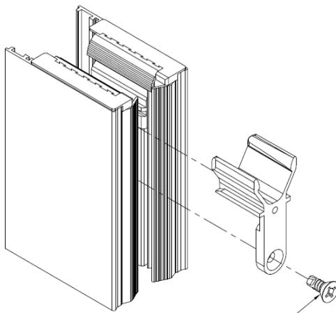
Mettre en place les anti-dégondages hauts avec les vis autoforeuses SR2 inox 4.8x13 fournies
