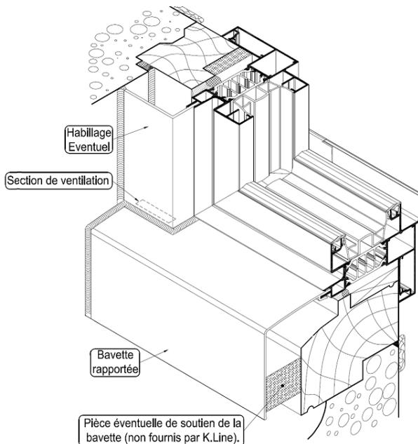
– Poser l'habillage vertical éventuel en appui sur la bavette. En extrémité de celle-ci, ménager une section de ventilation (encoche).
