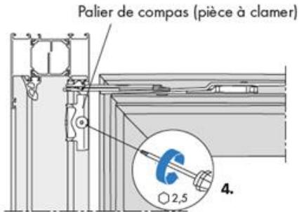
**4** Desserrer la vis de la pièce à clamer au niveau du palier de compas, ne pas dévisser entièrement.
