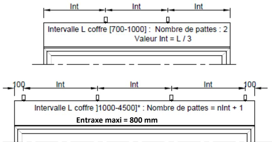
Avant la fixation s'assurer que la traverse haute ne présente aucune flèche.
