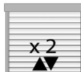
À la fin de l'enregistrement de la 2ème butée, le moteur confirme en s'actionnant 2 fois
