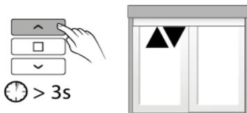
Puis, appuyez ~3 secondes sur la touche
