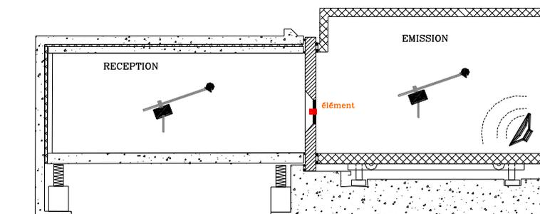
Calcul de l'isolement acoustique normalisé d'un élément  $D_{n,e}$  en dB pour chaque tiers d'octave :
