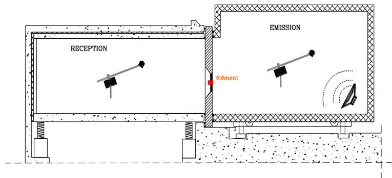
Calcul de l'isolement acoustique normalisé d'un élément  $D_{n,e}$  en dB pour chaque tiers d'octave :
