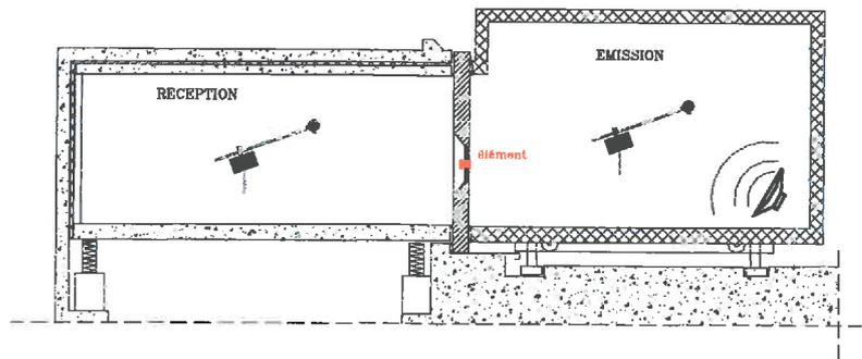
Calcul de l'isolement acoustique normalisé d'un élément  $D_{n,e}$  en dB pour chaque tiers d'octave :
