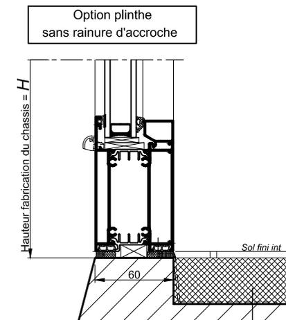
Nota : Jeu de 5mm en bas du dormant déjà inclus dans la hauteur du châssis.
