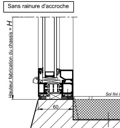
Nota : Jeu de 5mm en bas du dormant déjà inclus dans la hauteur du châssis.
