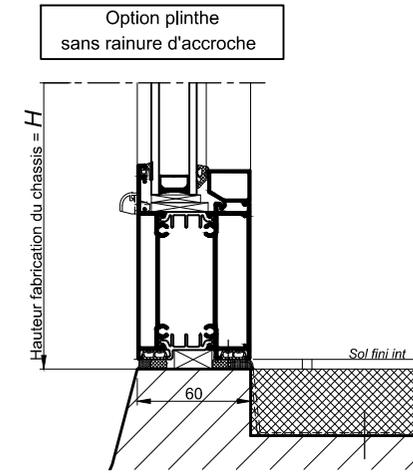
Nota : Jeu de 5mm en bas du dormant déjà inclus dans la hauteur du châssis.
