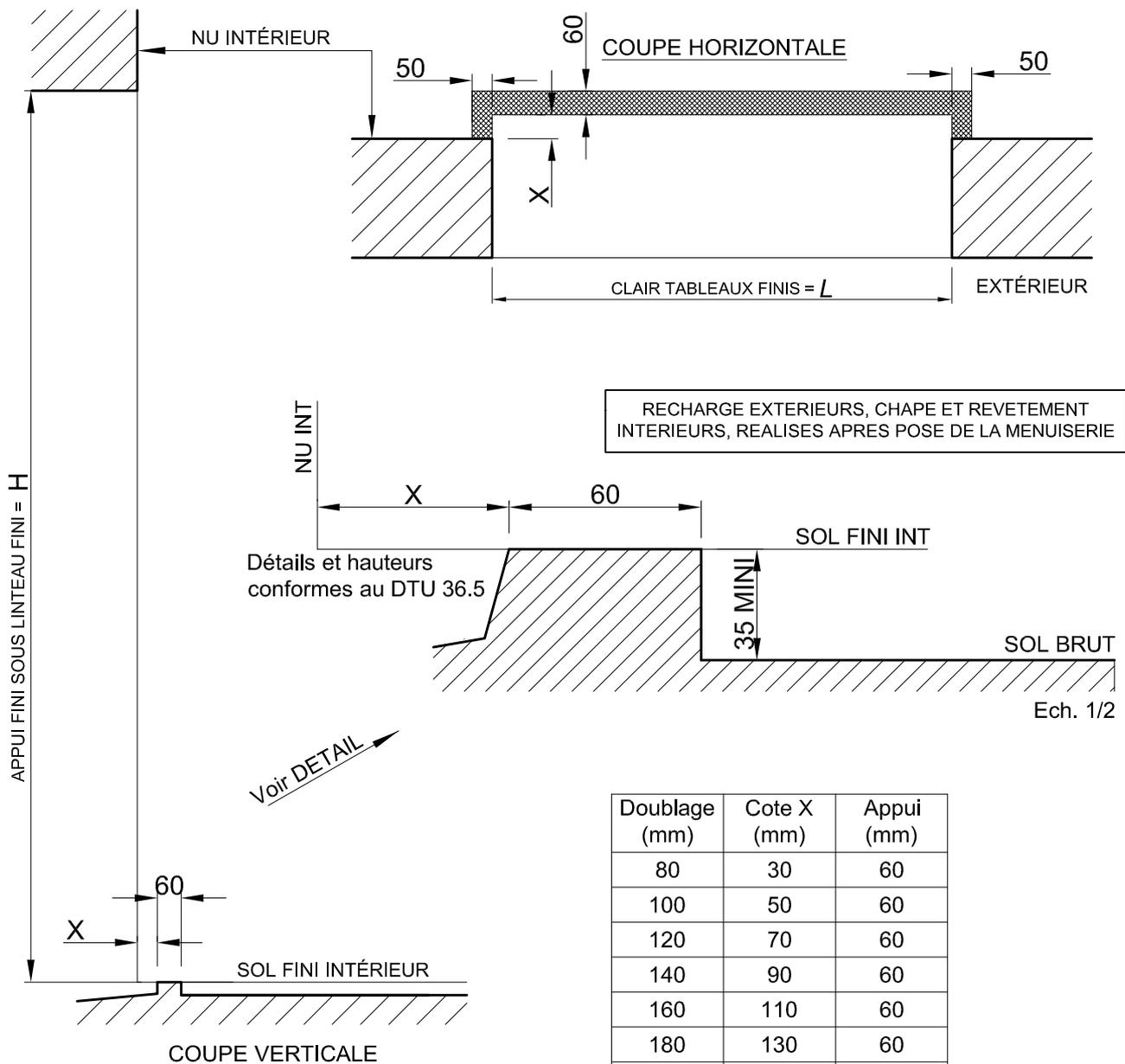
Attention : les ensembles KL-T doivent obligatoirement être posées sur des maçonneries finies.
