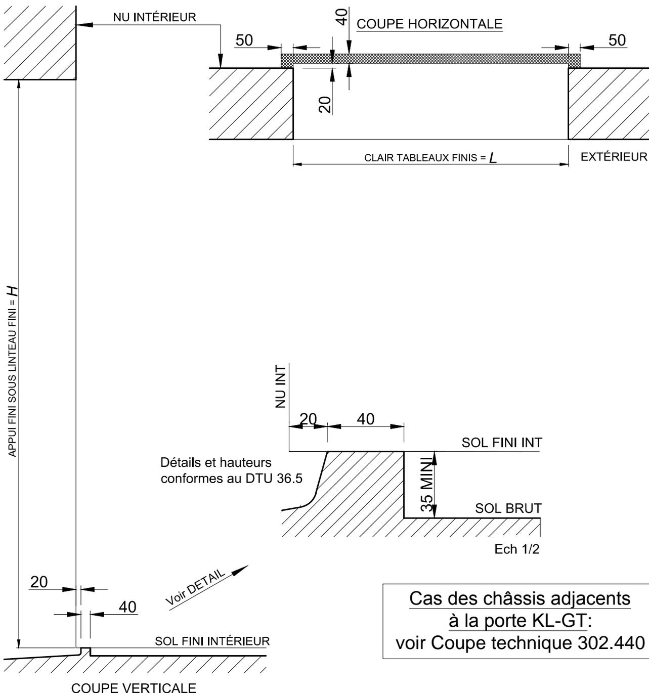
*Attention : les ensembles KL-T doivent obligatoirement être posées sur des maçonneries finies.*
