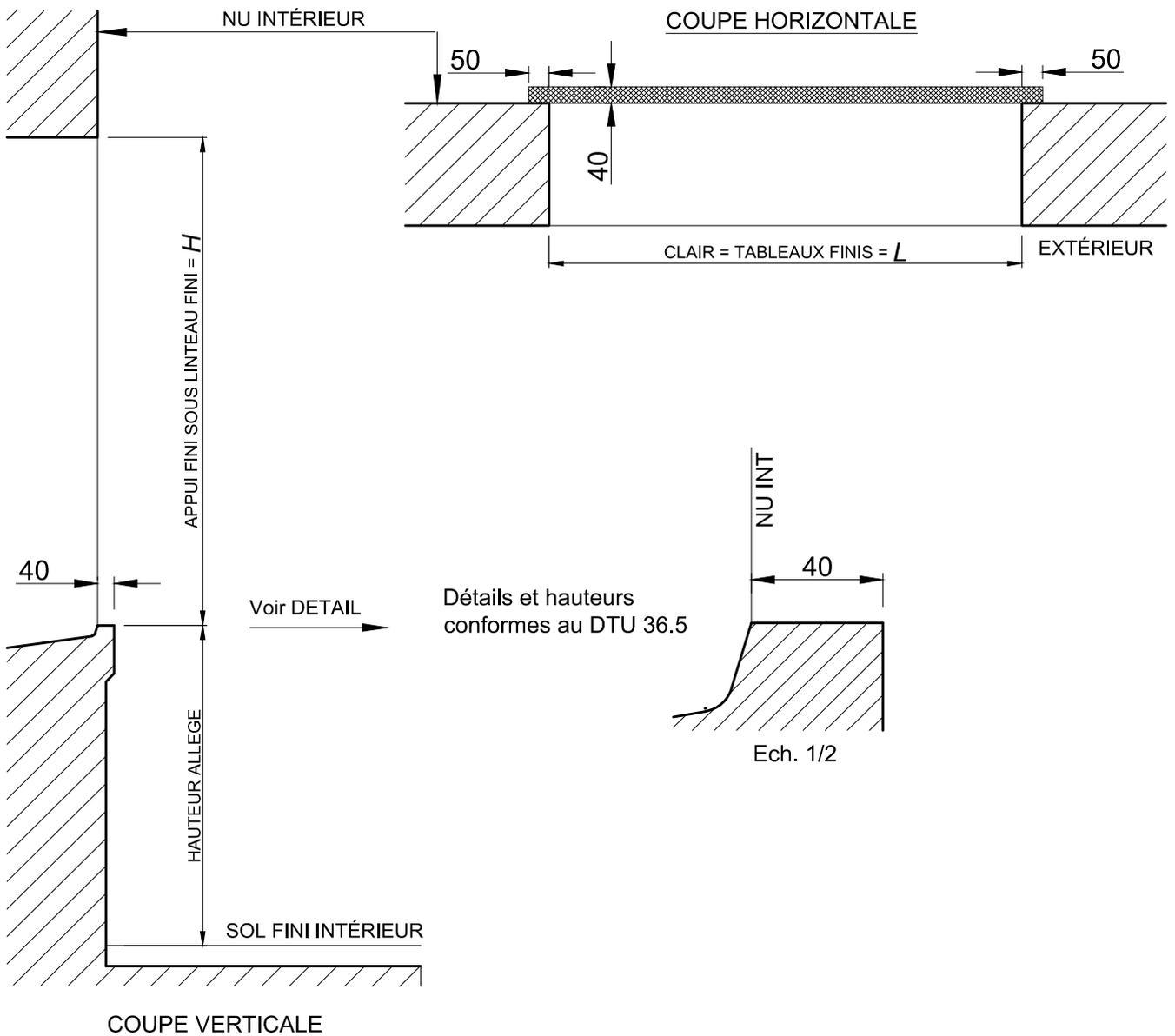
*Attention : les ensembles KL-T doivent obligatoirement être posés sur des maçonneries finies.*
