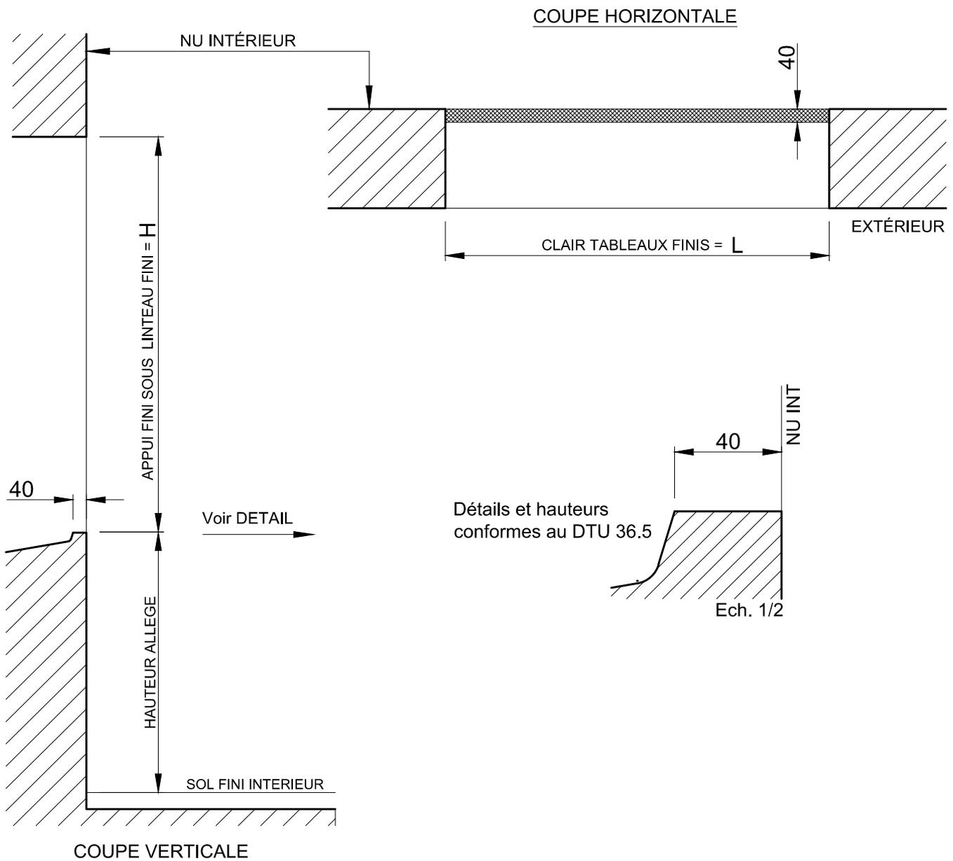
Attention : les ensembles KL-T doivent obligatoirement être posées sur des maçonneries finies.
