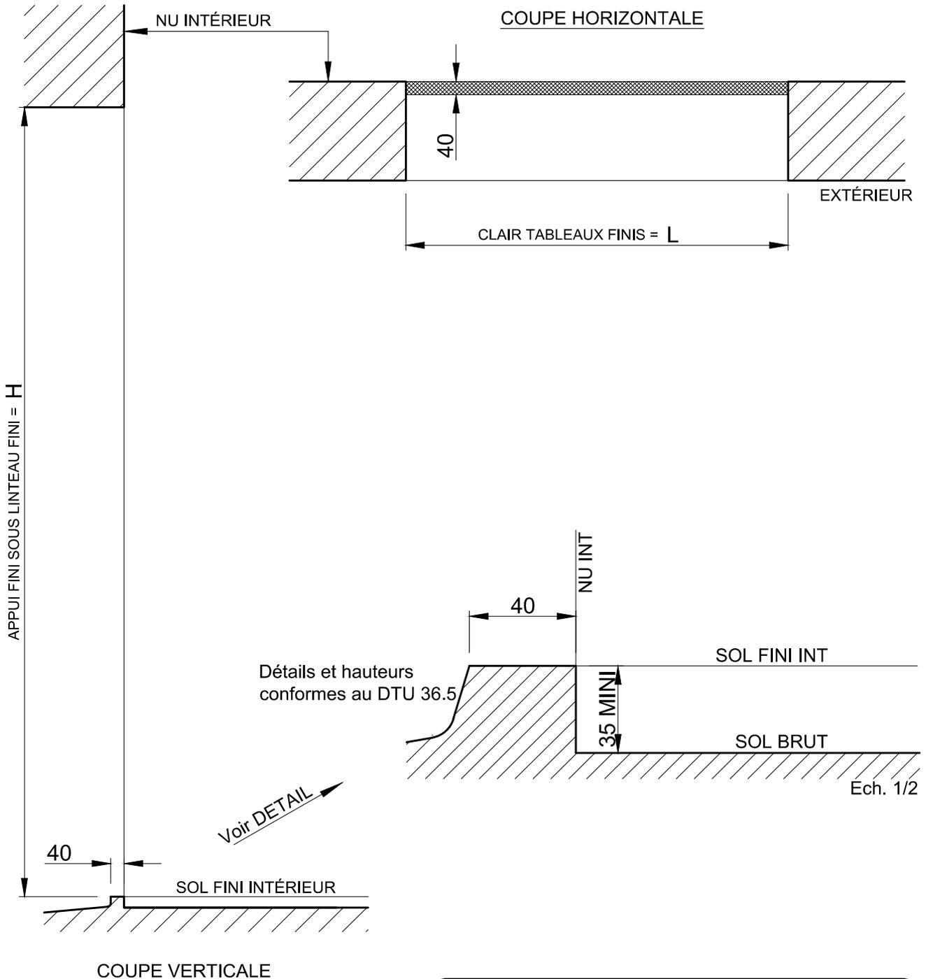
*Attention : les ensembles KL-T doivent obligatoirement être posés sur des maçonneries finies.*
