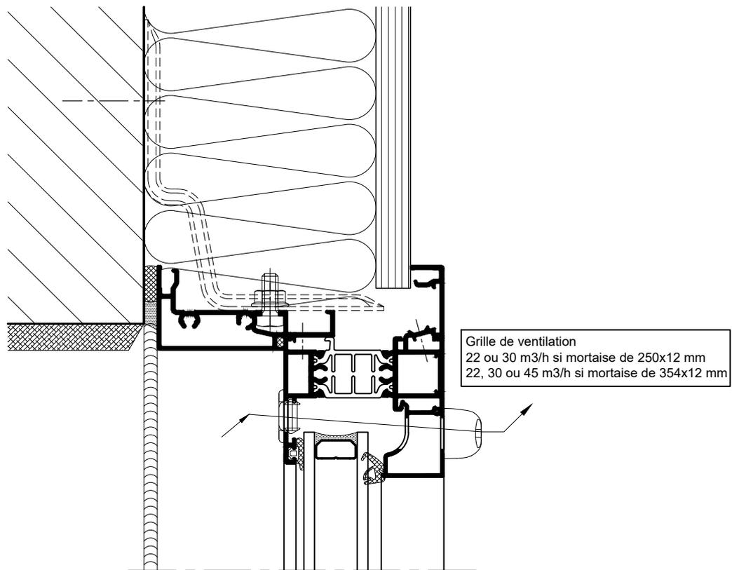
Réalisable en fixe parclosage intérieur avec remplissage d'épaisseurs 24, 30 ou 36mm
