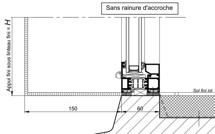
Nota : Jeu de 5mm en bas du dormant déjà inclus dans la hauteur du châssis.
