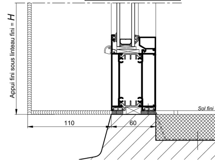
Nota : Jeu de 5mm en bas du dormant déjà inclus dans la hauteur du châssis.
