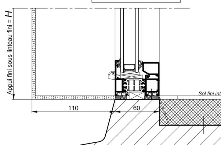
Nota : Jeu de 5mm en bas du dormant déjà inclus dans la hauteur du châssis.
