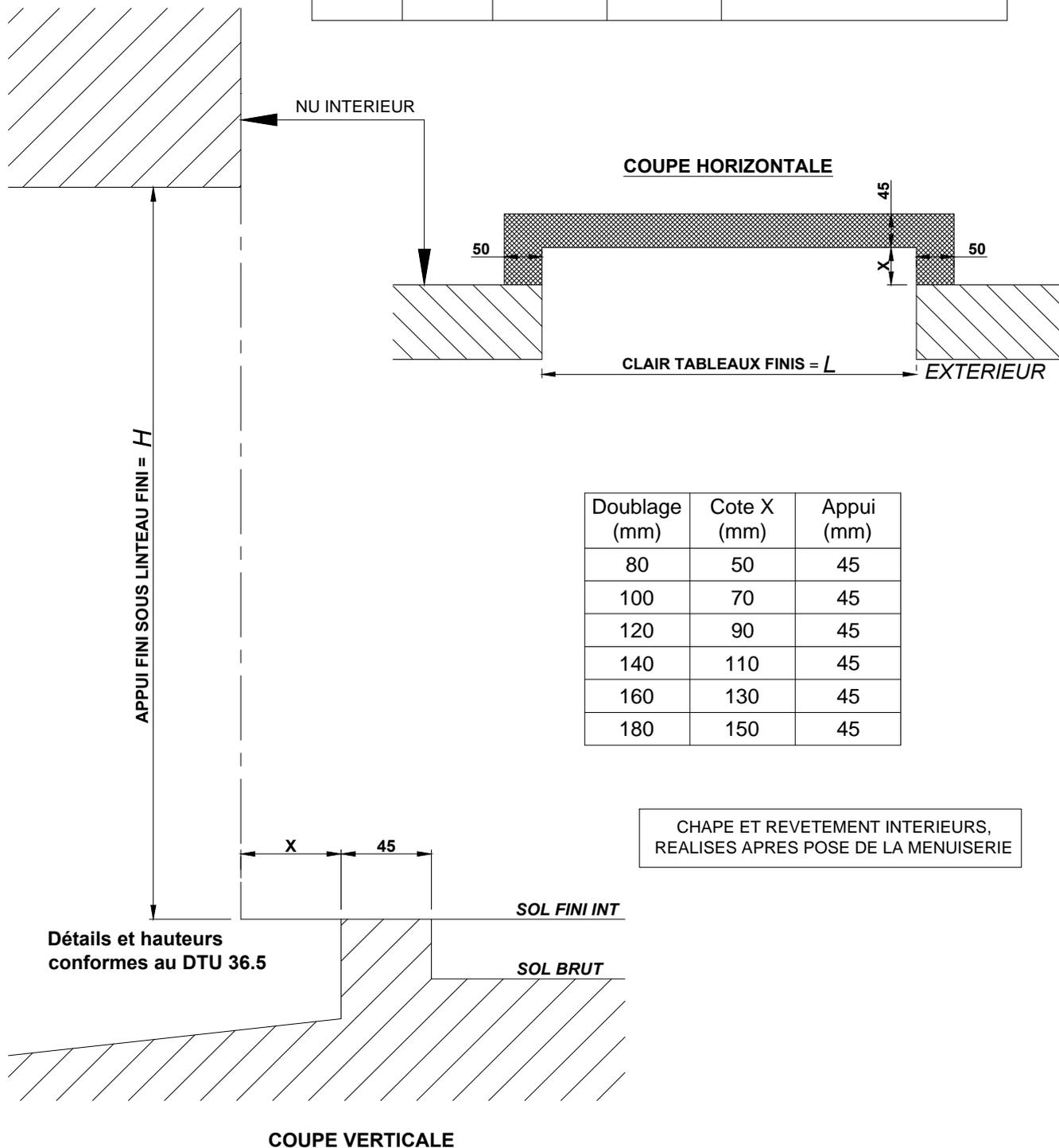
Attention : Les portes de service K.Line doivent obligatoirement être posées sur des maçonneries finies.
