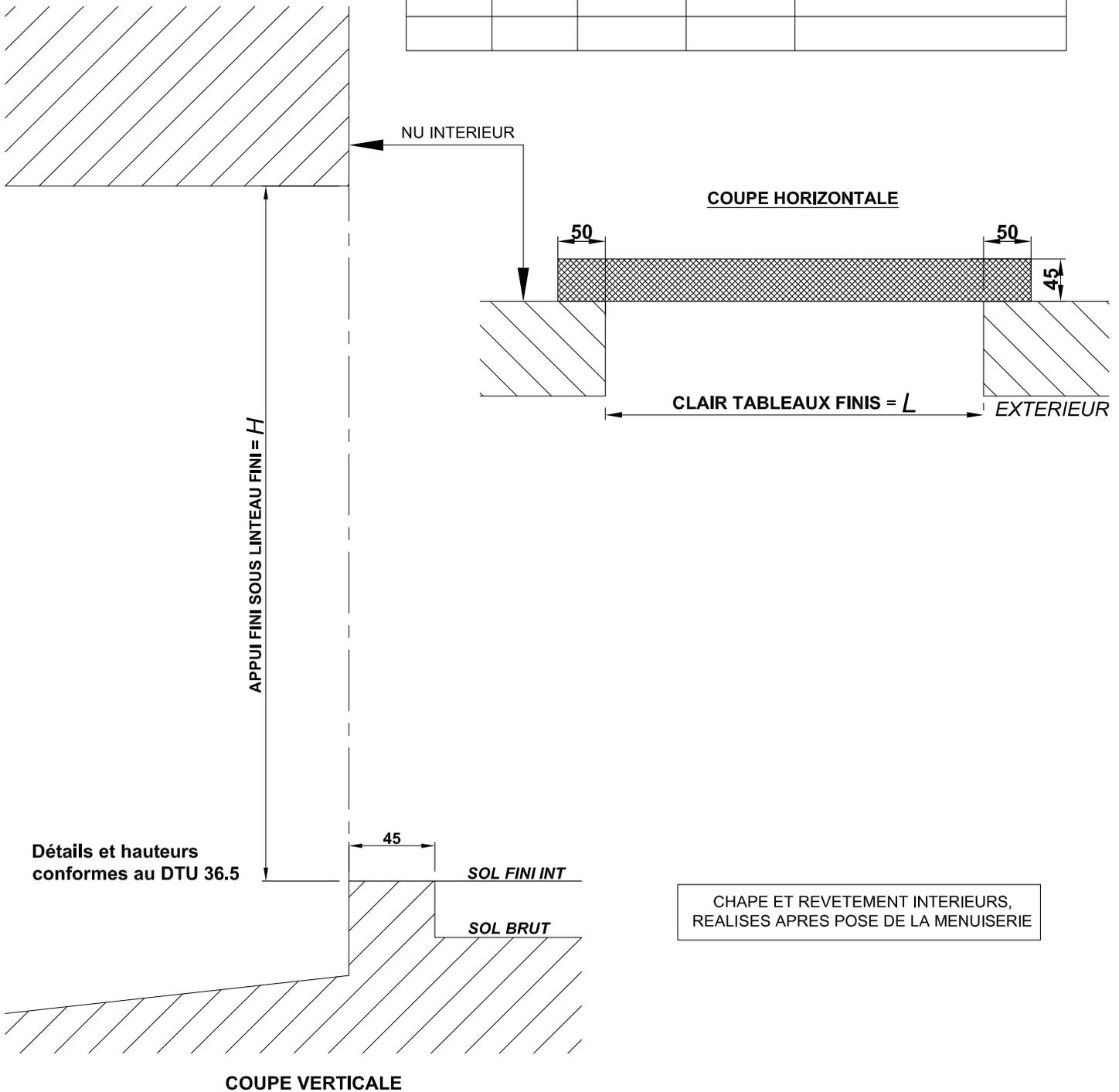
**Attention : Les portes de service K.Line doivent obligatoirement être posées sur des maçonneries finies.**
