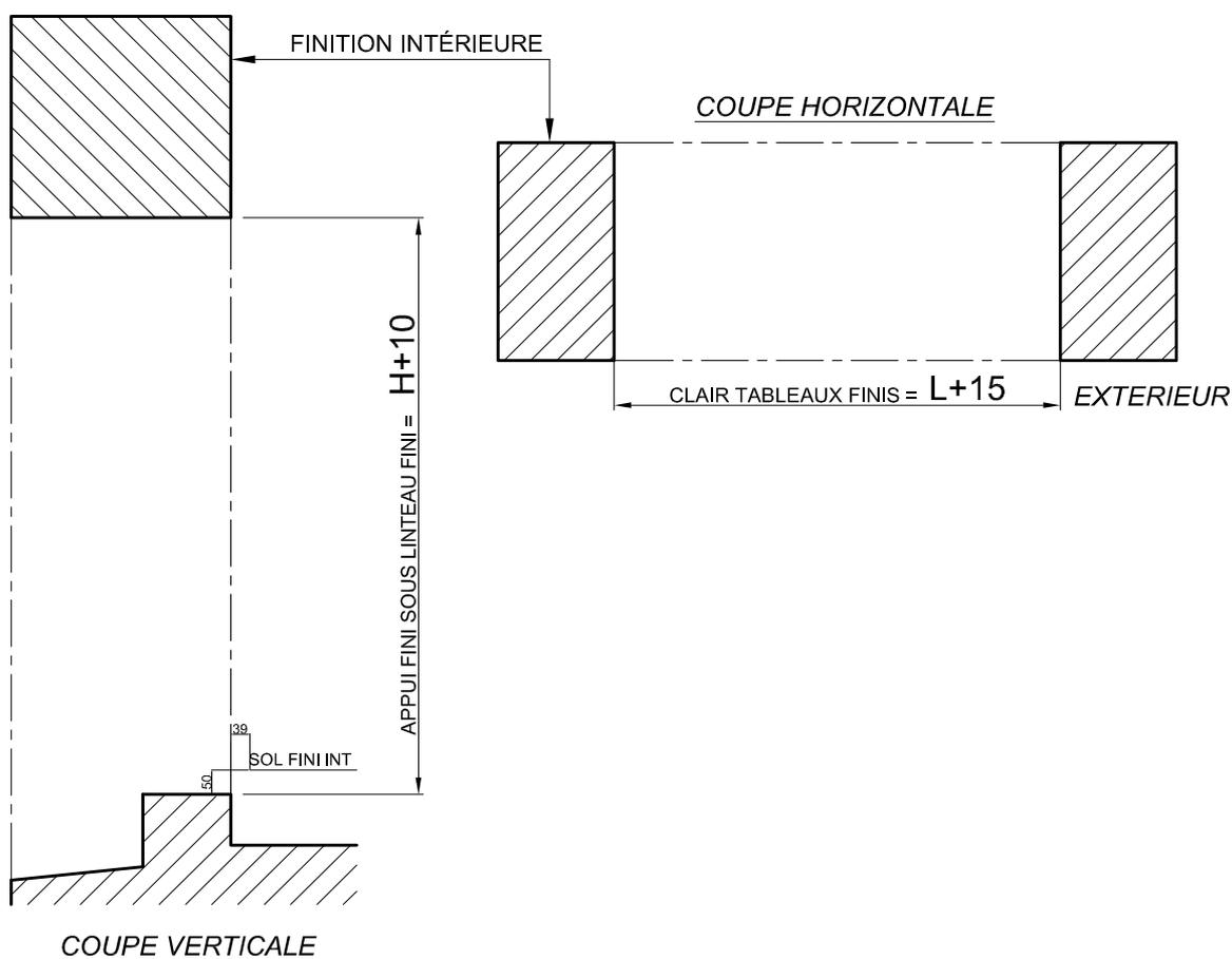
Attention : Les chassis K.LINE doivent obligatoirement être posées sur des maçonneries finies.
