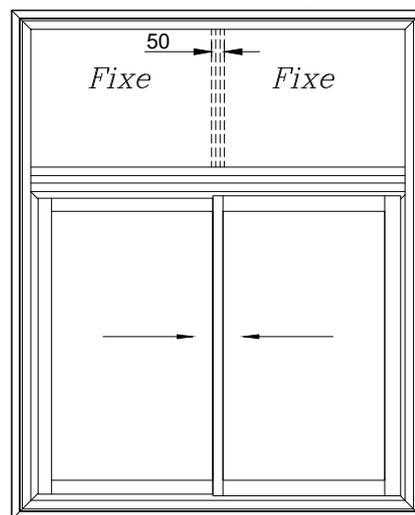
La mise en oeuvre doit être effectuée en respect des règles, normes et DTU en vigueur. Sous charges d'exploitation, la déformation verticale de la structure devra être limitée à 3mm.
