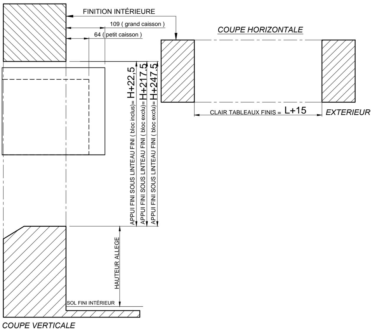
Attention : Les chassis K.LINE doivent obligatoirement être posées sur des maçonneries finies.
