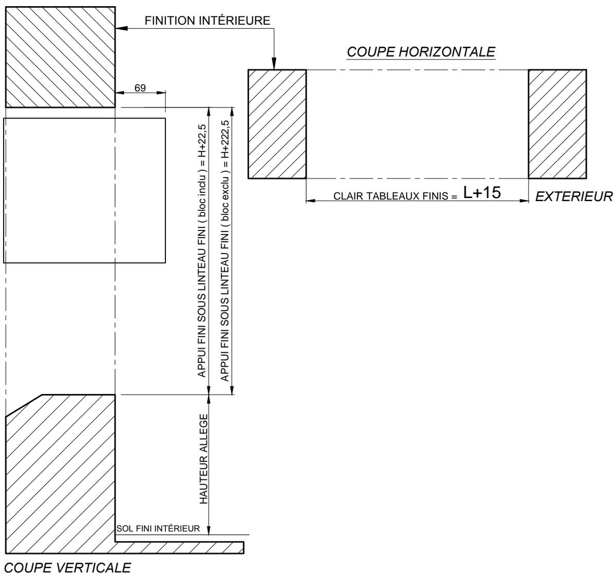
Attention : Les chassis K.LINE doivent obligatoirement être posées sur des maçonneries finies.
