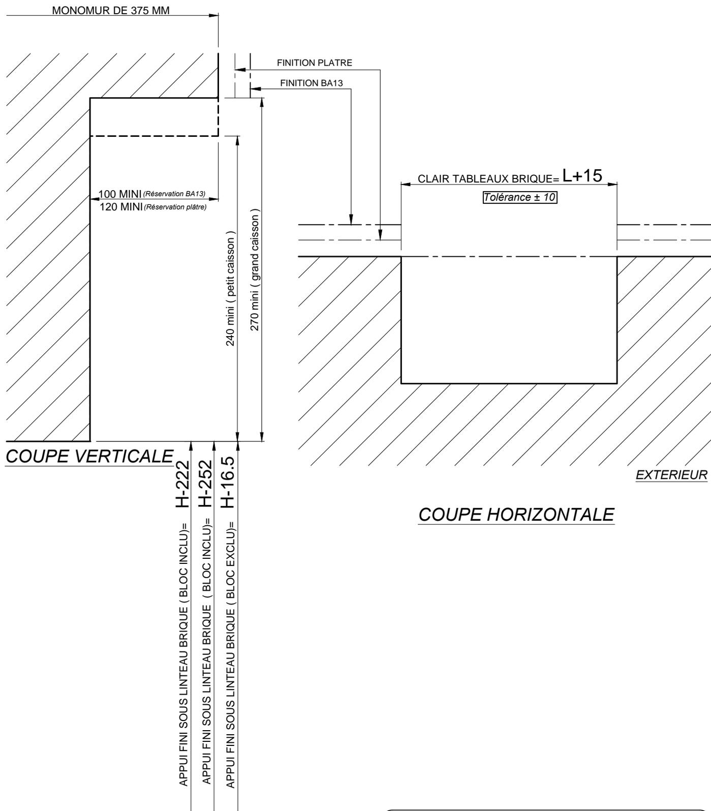
Nota: Les détails bas sont fonction du type de pose et de l'épaisseur de doublage.
