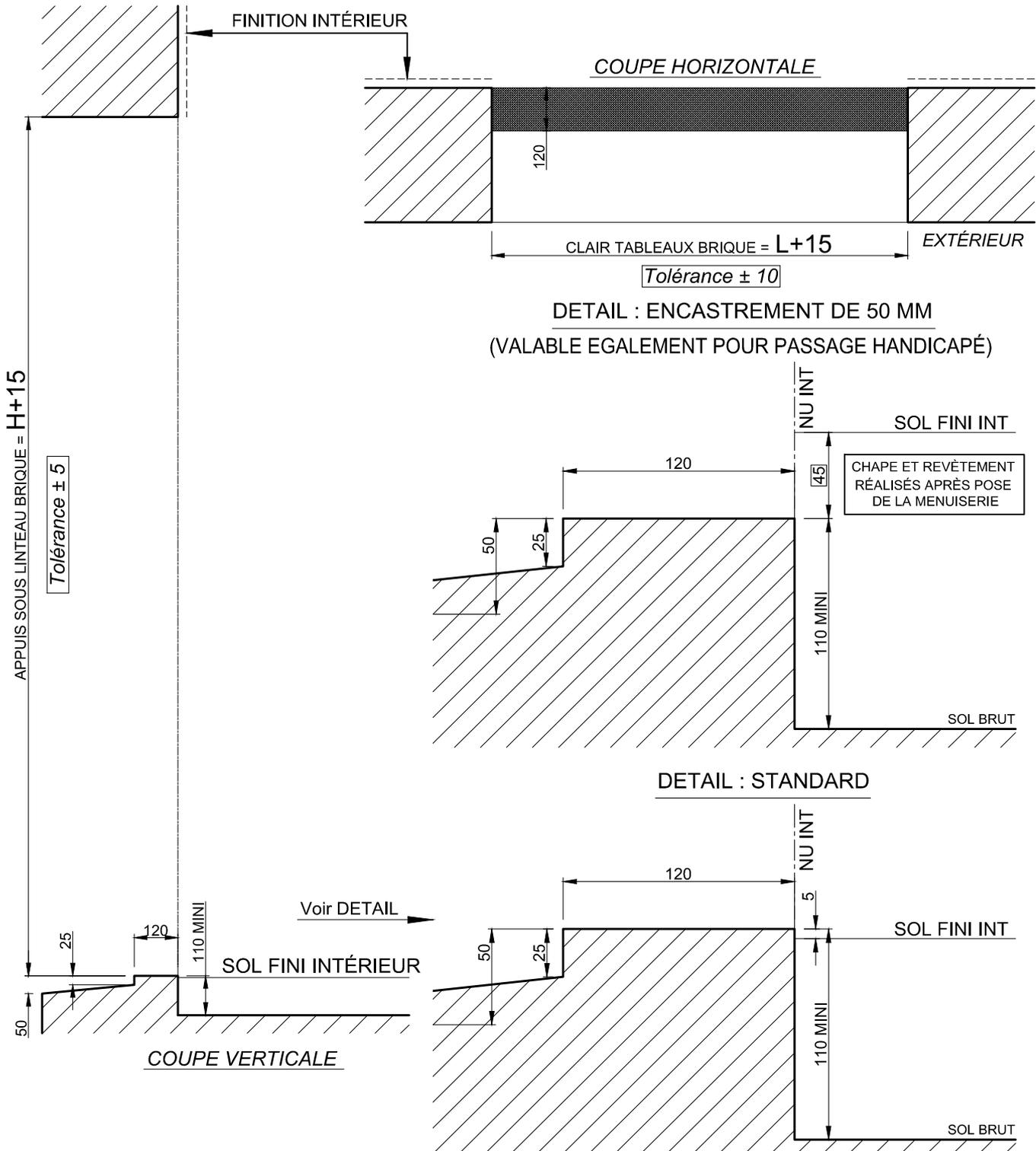
Attention : les châssis K.line doivent obligatoirement être posées sur des maçonneries finies.
