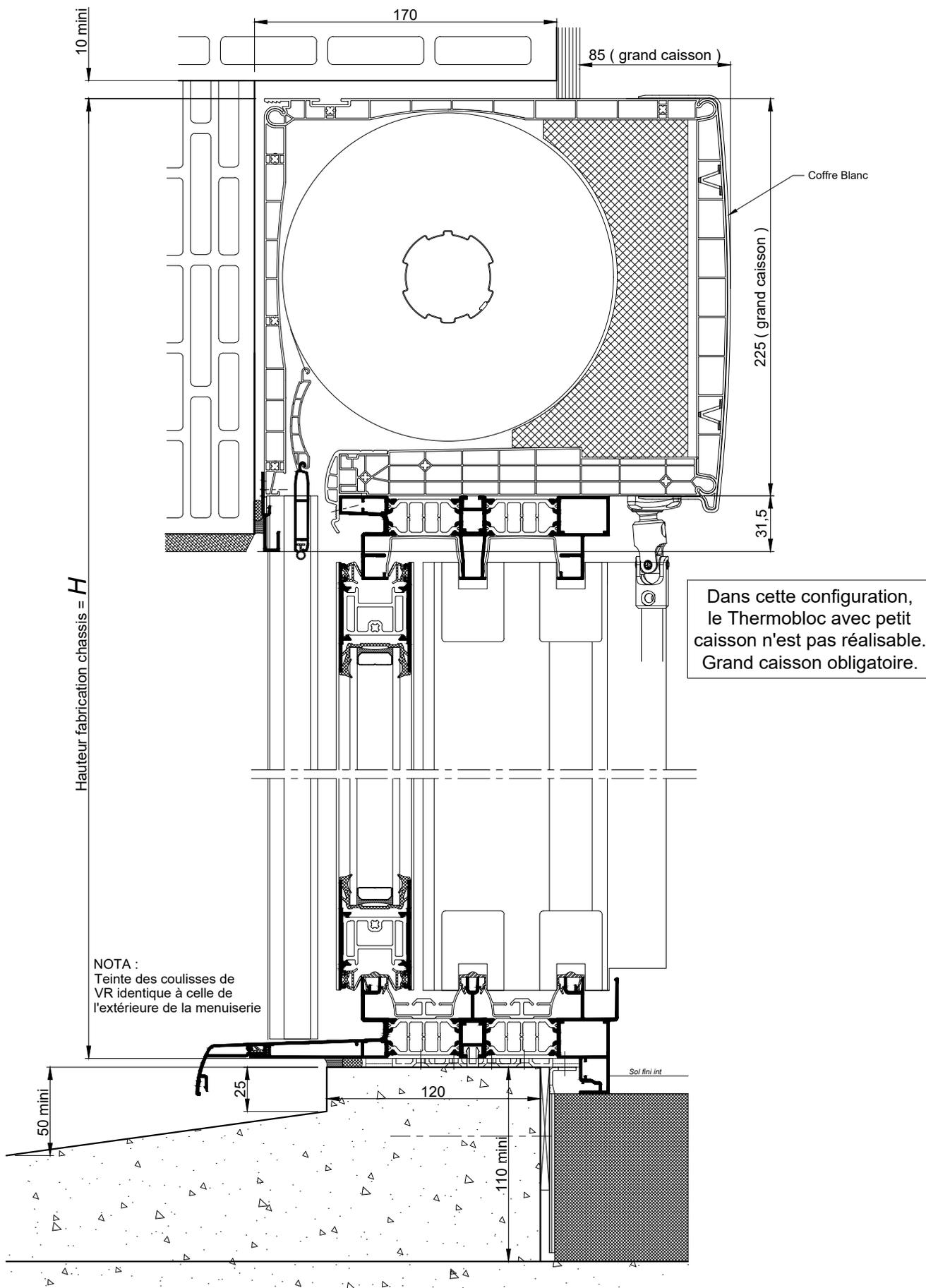
La mise en oeuvre doit être effectuée en respect des règles, normes et DTU en vigueur. Sous charges d'exploitation, la déformation verticale de la structure devra être limitée à 3mm.
