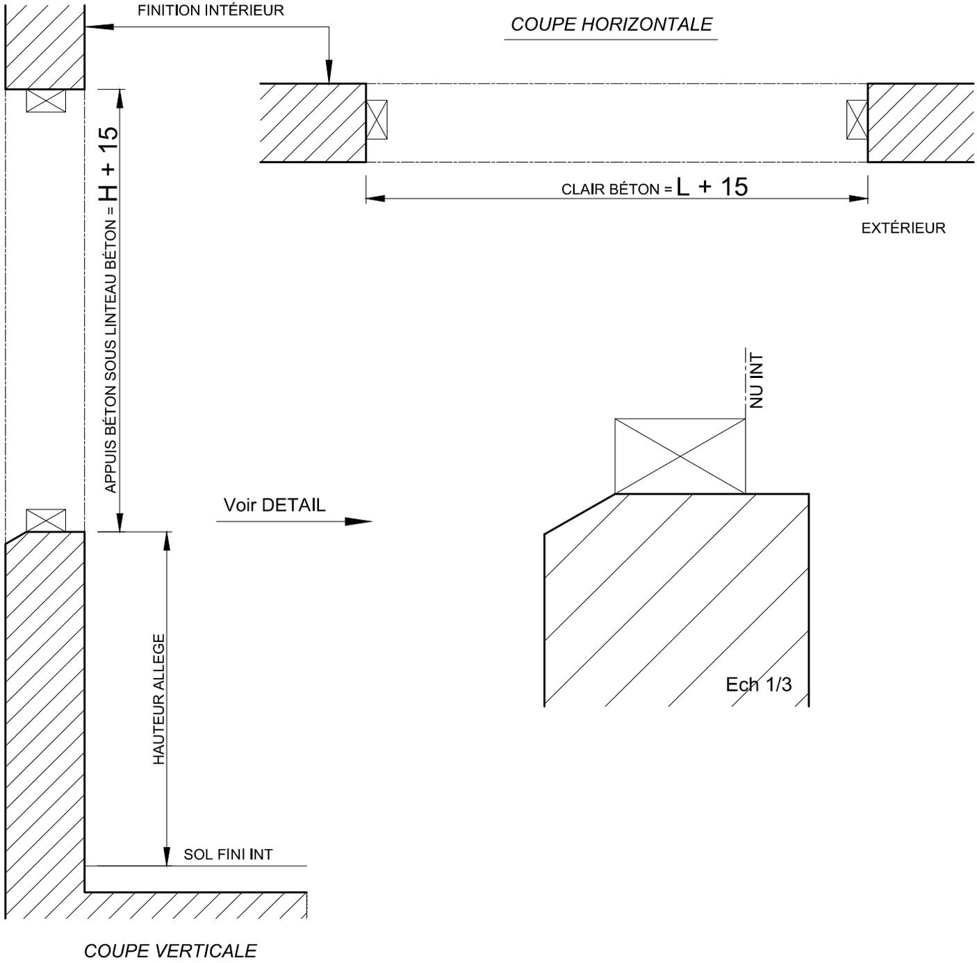
**Attention : les coulissants K.line doivent obligatoirement être posés sur des maçonneries finies.**
