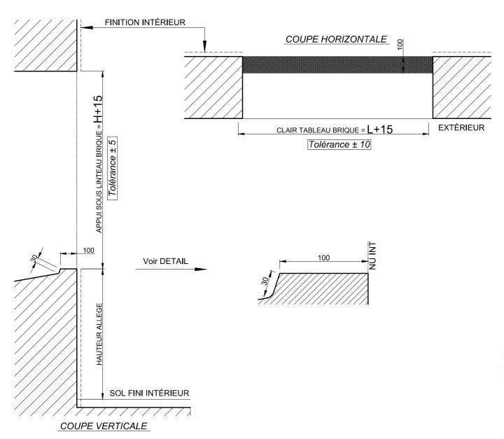
Attention : les châssis K.line doivent obligatoirement être posées sur des maçonneries finies.
