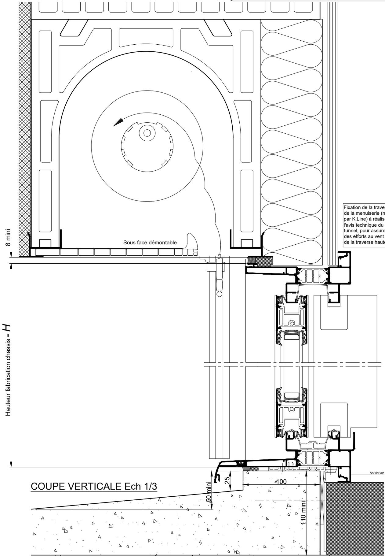
Fixation de la traverse haute de la menuiserie (non fournis par K.Line) à réaliser suivant l'avis technique du coffre tunnel, pour assurer la reprise des efforts au vent et au poids de la traverse haute.
