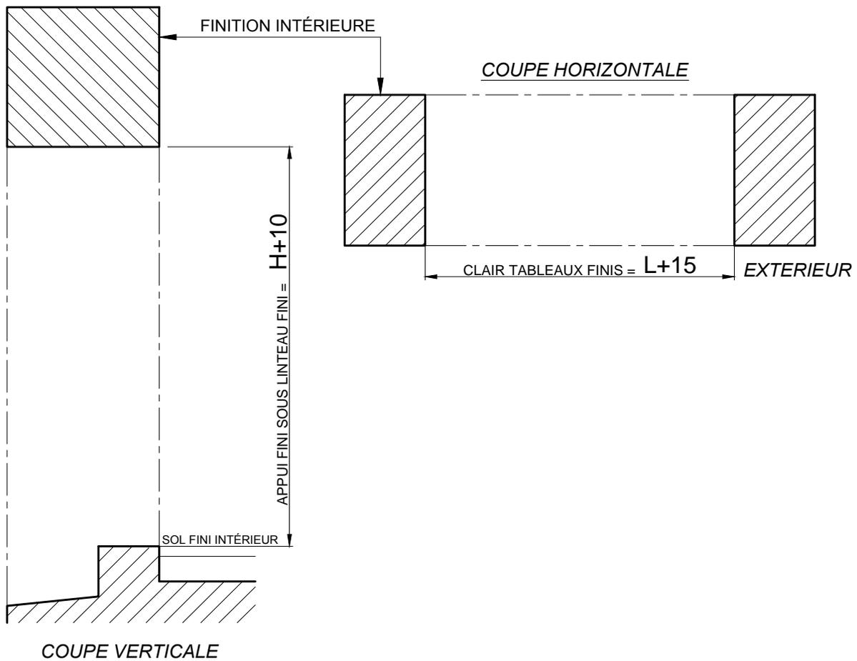
Attention : Les châssis K.LINE doivent obligatoirement être posés sur des maçonneries finies.
