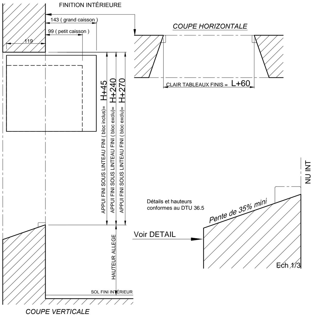
Attention : Les chassis K.LINE doivent obligatoirement être posées sur des maçonneries finies.
