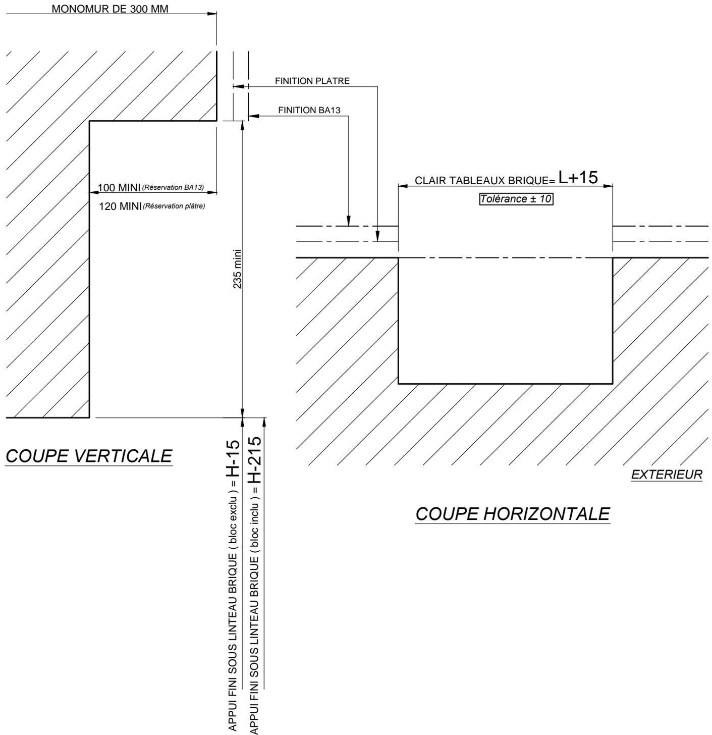
Nota: Les détails bas sont fonction du type de pose et de l'épaisseur de doublage.
