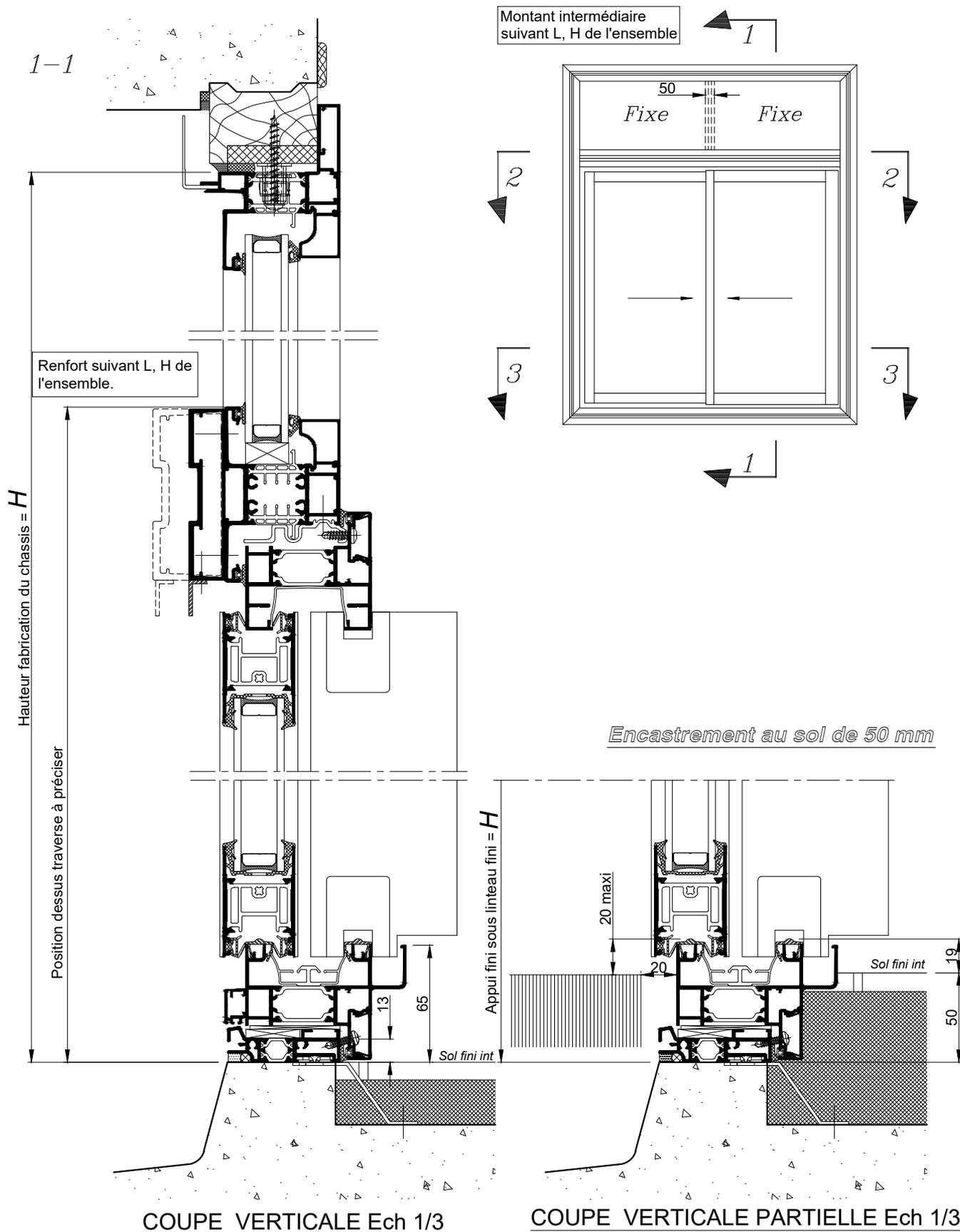
La mise en oeuvre doit être effectuée en respect des règles, normes et DTU en vigueur. Sous charges d'exploitation, la déformation verticale de la structure devra être limitée à 3mm.
