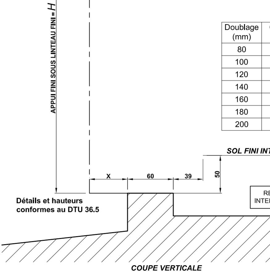
RECHARGE EXTERIEURS, CHAPE ET REVETEMENT INTERIEURS, REALISES APRES POSE DE LA MENUISERIE
