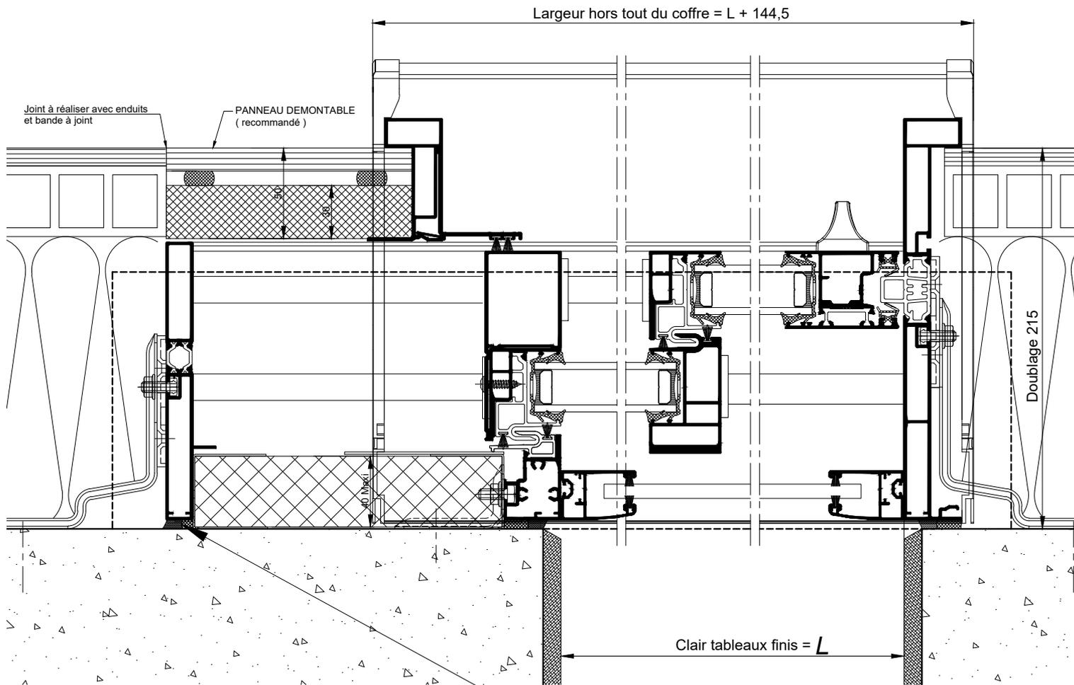
NOTA: L'étanchéité à l'air doit être assurée entre la zone de refoulement et le doublage
