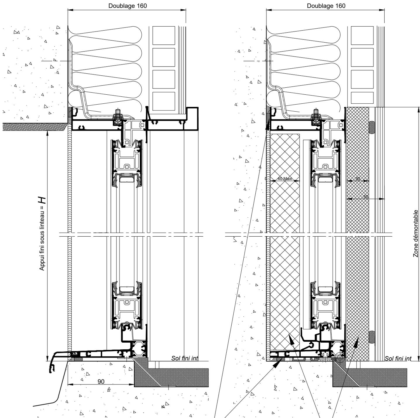
NOTA: L'étanchéité à l'air doit être assurée entre la zone de refolement et le doublage
