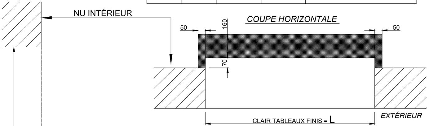
**DETAIL : ENCASTREMENT DE 50 MM
