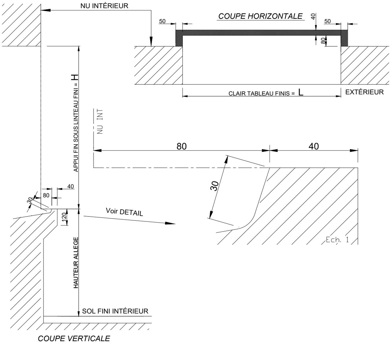
**Attention : les menuiseries K.line doivent obligatoirement être posées sur des maçonneries finies.**
