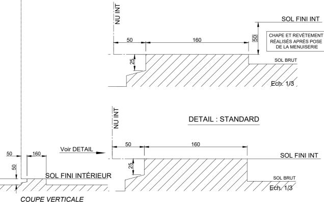
Attention : les menuiseries K.line doivent obligatoirement être posées sur des maçonneries finies.
