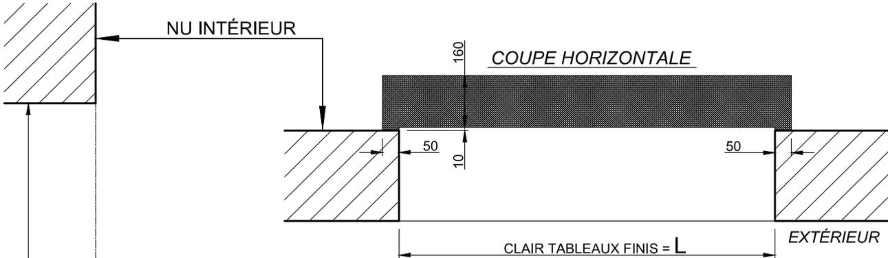
**DETAIL : ENCASTREMENT DE 50 MM
