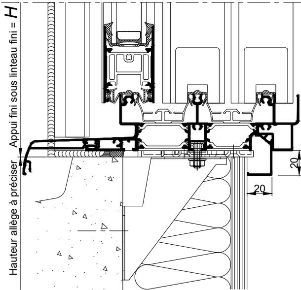
Appui fini sous linteau fini = H
