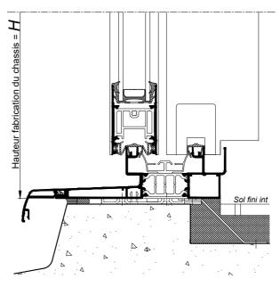
Appui large rénovation et traverse basse sans aile.
