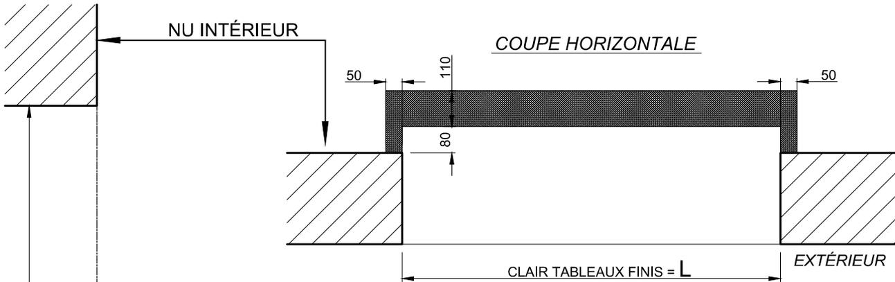
**DETAIL : ENCASTREMENT DE 50 MM**
