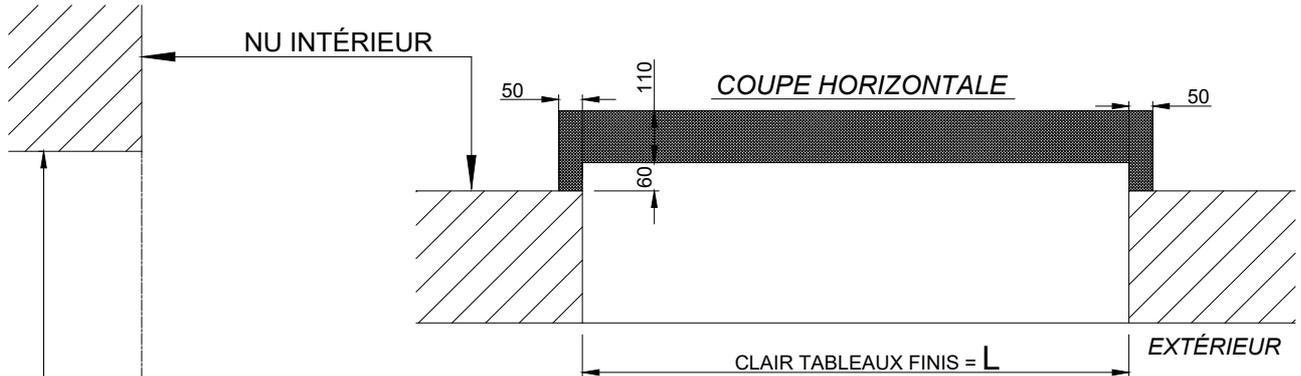
**DETAIL : ENCASTREMENT DE 50 MM**
