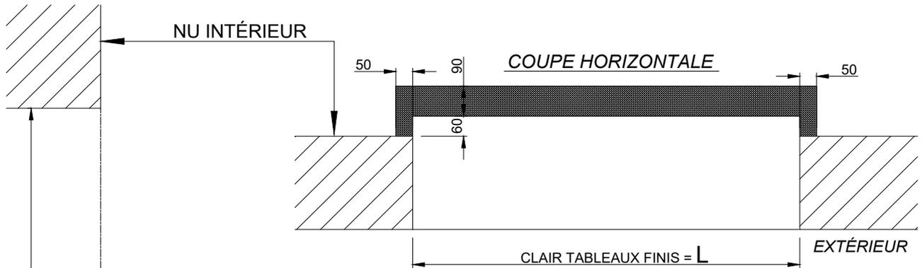
**DETAIL : ENCASTREMENT DE 50 MM**
