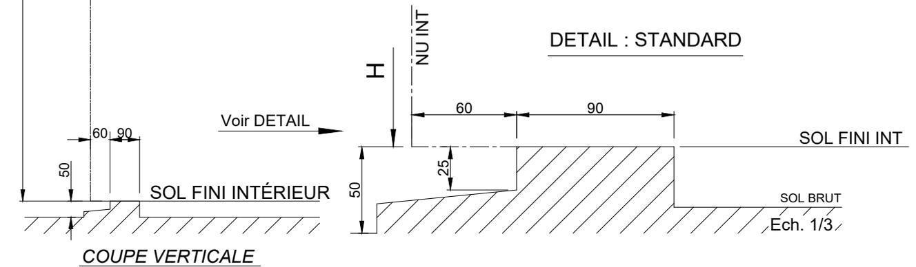
**Attention : les menuiseries K.line doivent obligatoirement être posées sur des maçonneries finies.**
