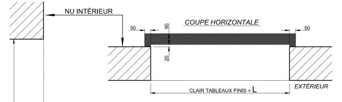
DETAIL : ENCASTREMENT DE 50 MM (VALABLE EGALEMENT POUR PASSAGE HANDICAPÉ)
