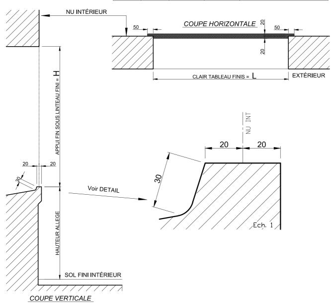
Attention : les menuiseries K.line doivent obligatoirement être posées sur des maçonneries finies.
