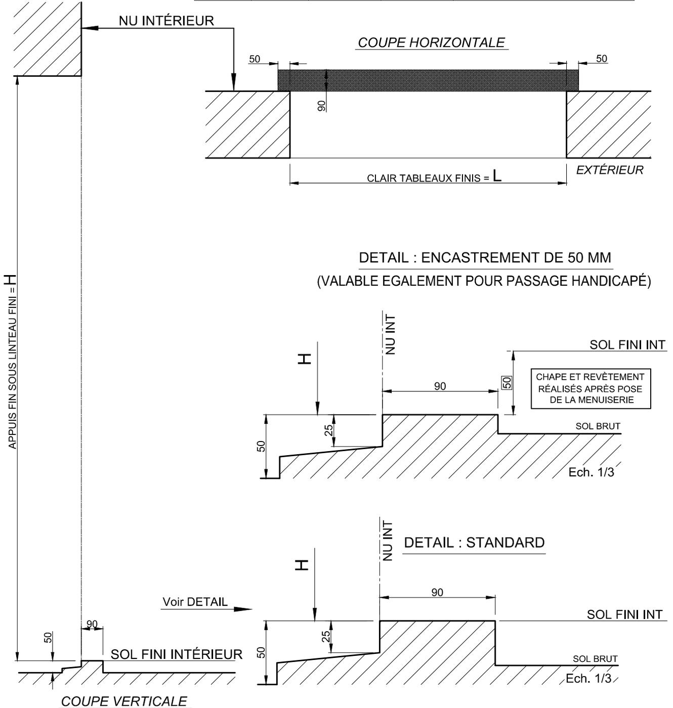
**Attention : les menuiseries K.line doivent obligatoirement être posées sur des maçonneries finies.**
