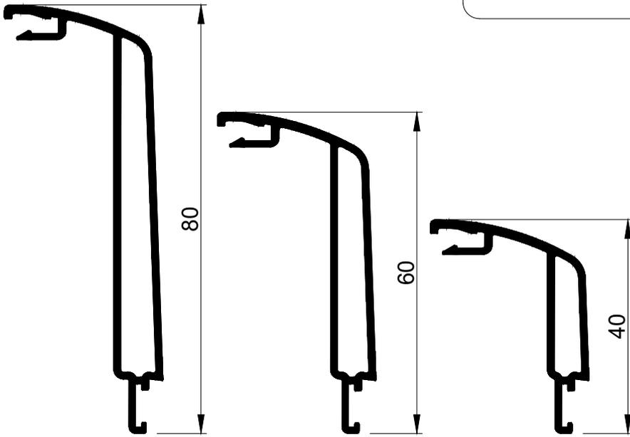
Les dimensions du profil d'appui et de la bavette sont imposés par le doublage et la hauteur d'allège. Se reporter aux plans 103.050 à 103.075.
